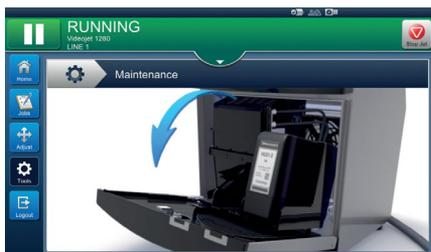
Наша система Videojet Smart Cartridge™ позволяет избежать грязи, отходов производства и ошибок, полностью израсходовать чернила из картриджа, а также предлагает дополнительную защиту от протекания при транспортировке и подготовке к эксплуатации. Конструкция Videojet SmartCell™ также упрощает плановое техническое обслуживание.
